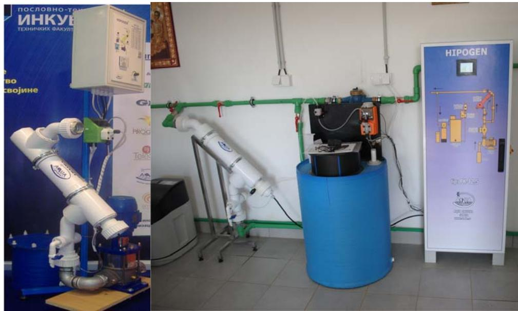
Slika 6. Elektrohemski uređaj za proizvodnju dezinficijensa sa koaksijalnim plag reaktorom
